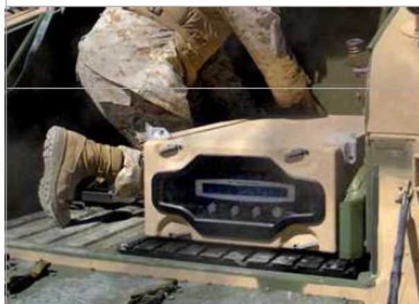
Корпус 19 " Mitraset ® Classic: усиленная конструкция и специальная крышка для эксплуатации внутри транспортного средства
